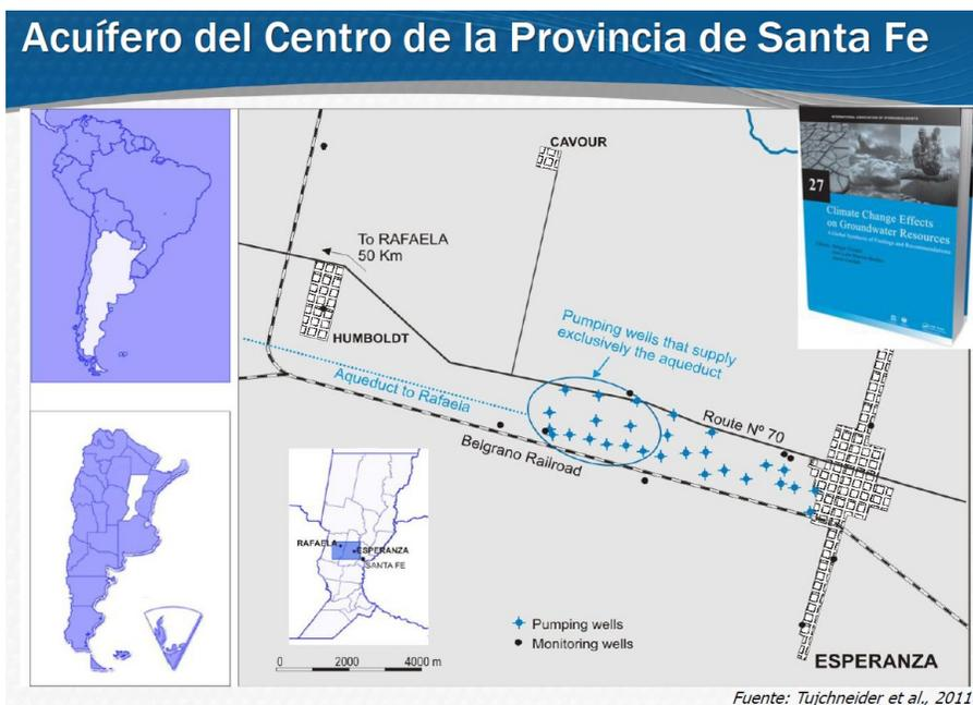
Figura 24: Un caso expuesto fue el que realizaron las capacitadoras en la Provincia de Santa Fe en Argentina, en donde determinaron el modelo hidrogeológico presente, y posteriormente modelaron matemáticamente el sistema para conocer la dirección de flujo del agua subterránea y la cantidad de agua que quedaba disponible en el sistema.
